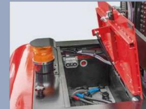
Nach dem Öffnen der Klappe besteht einfach Zugriff auf Hydraulikeinheit, Elektroniksteuerung und Motor
