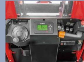
FREIER Beschleunigungshebel mit Sensor beugt Fehlbedienung vor
